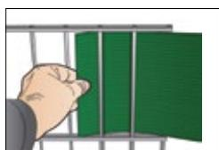
Eine 50 Meter Rolle ist ausreichend für ca. 19 Bahnen á 2550 mm Länge. Beginnen Sie bei der Montage am Anfang des Zauns und fädeln Sie die Streifen in die Zaunstreben ein. Die Streifen werden je nach Pfostenausführung zwischen Pfosten und Abdeckschiene eingeschoben oder über den Zaunpfahl hinweg gespannt. Zusätzliches Befestigungsmaterial ist nicht erforderlich.
